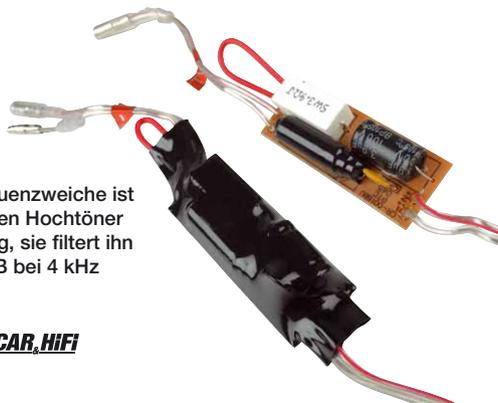
Die Frequenzweiche ist nur für den Hochtöner zuständig, sie filtert ihn mit 12 dB bei 4 kHz
